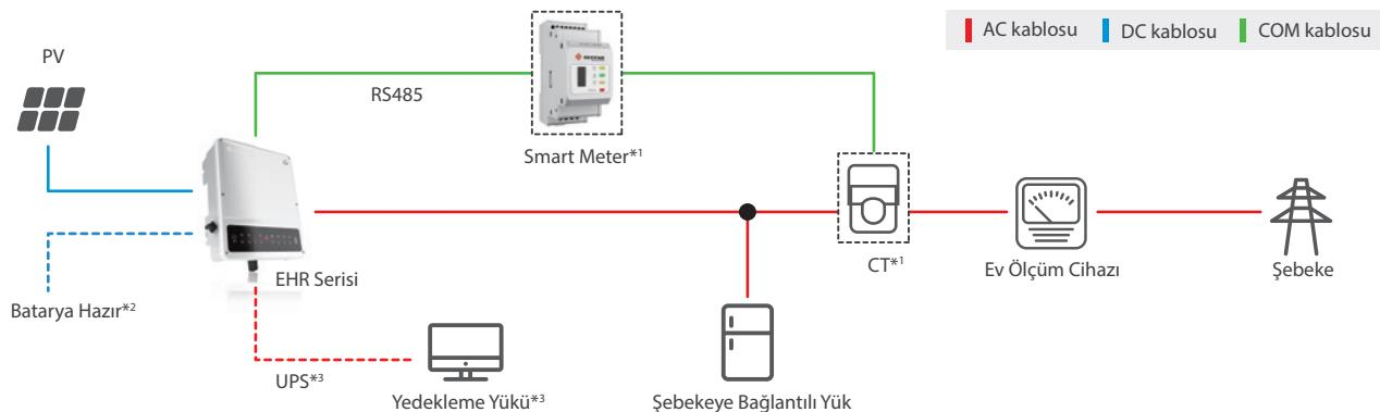
\*<sup>1</sup> Smart Meter bağlantıları önceden yapılmış bir CT (akım transformatörü) içeren isteğe bağlı bir pakette gelir.
