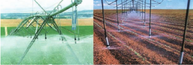
Resim 3.19 Dairesel hareketli (center pivot) yağmurlama sulama sistemi
