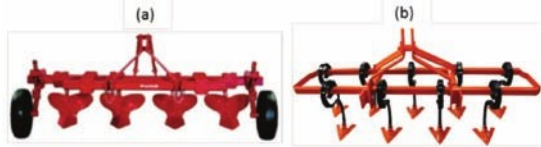
Resim 3.10 Boğaz doldurma (lister) (a) ve kültivatör (b)
