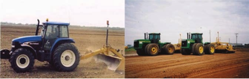
Resim 3.1 Arazi tesviyesi yüzey sulama yöntemlerinin etkili olarak uygulanması için gerekli en önemli unsurlardan birisidir.
