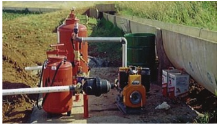
Resim 3.28 Bir damlama sulama sisteminde kontrol ünitesi (motopomp, kum-çakıl tankı, gübre tankı ve filtreler)
