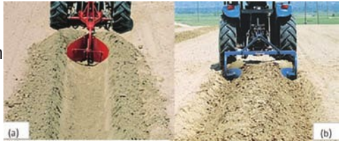
Resim 3.9 Kanal açma pulluğu (a) ve sedde pulluğu (b)
